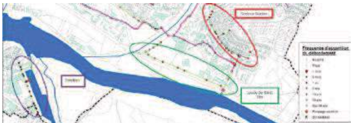
Figure 48 : Fréquence d'apparition des débordements sur le réseau pluvial – Secteur Baratte à Nevers. Source : SDA
