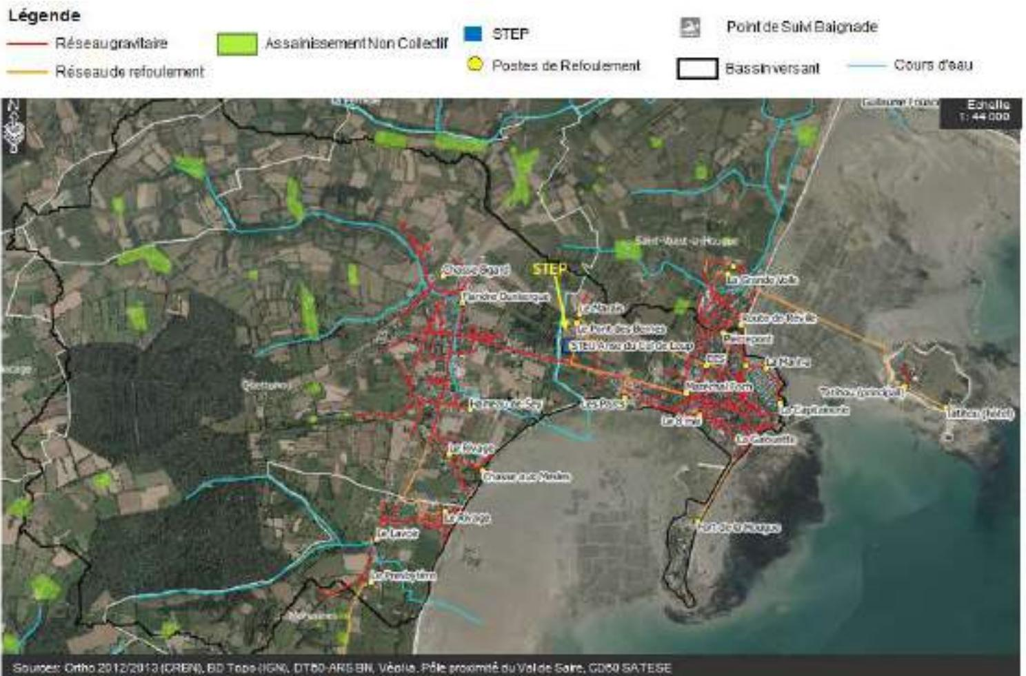
**Figure 35** : Localisation des réseaux d'assainissement collectif et zones d'assainissement non collectif sur la zone d'influence microbologique immédiate du secteur d'étude
