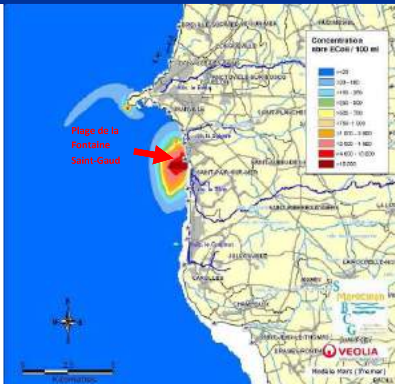
Figure 77 : Modélisation de l'impact du dysfonctionnement d'un ouvrage d'assainissement implanté sur le bassin versant du Thar – Projet Life Environnement Mareclean VERI 2009
