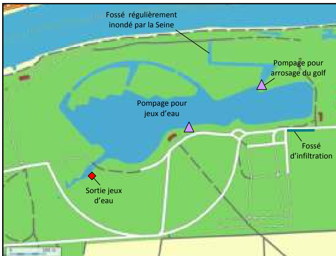
Figure 14 : Schématisation du fonctionnement hydraulique du plan d'eau
