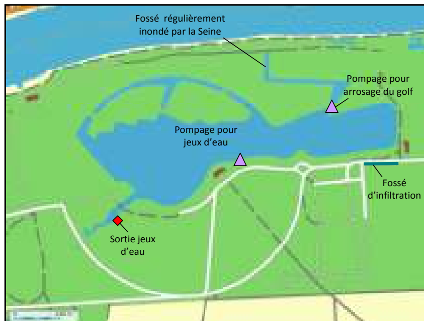
Figure 4 : Schématisation du fonctionnement hydraulique du plan d'eau
