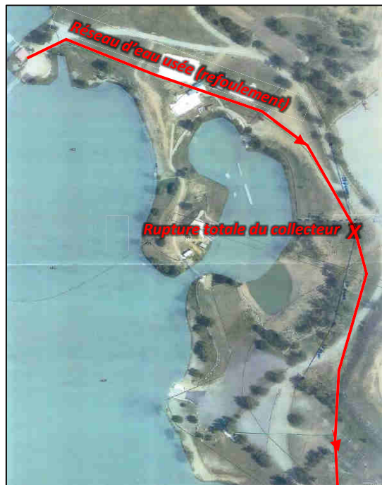
Figure 14: Réseau collectif de la zone aquatique et localisation de la rupture du réseau (investigation 2018)
